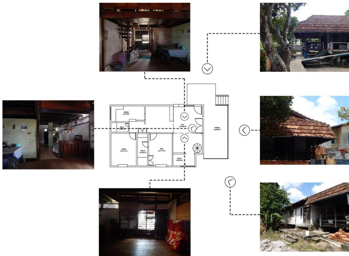
Figura 1: Distribución interna de los espacios (social y de servicios), aberturas con sistemas fijos (superior) y flexibles (inferior) y el balcón frontal, los aleros rotos y la elevación del piso
