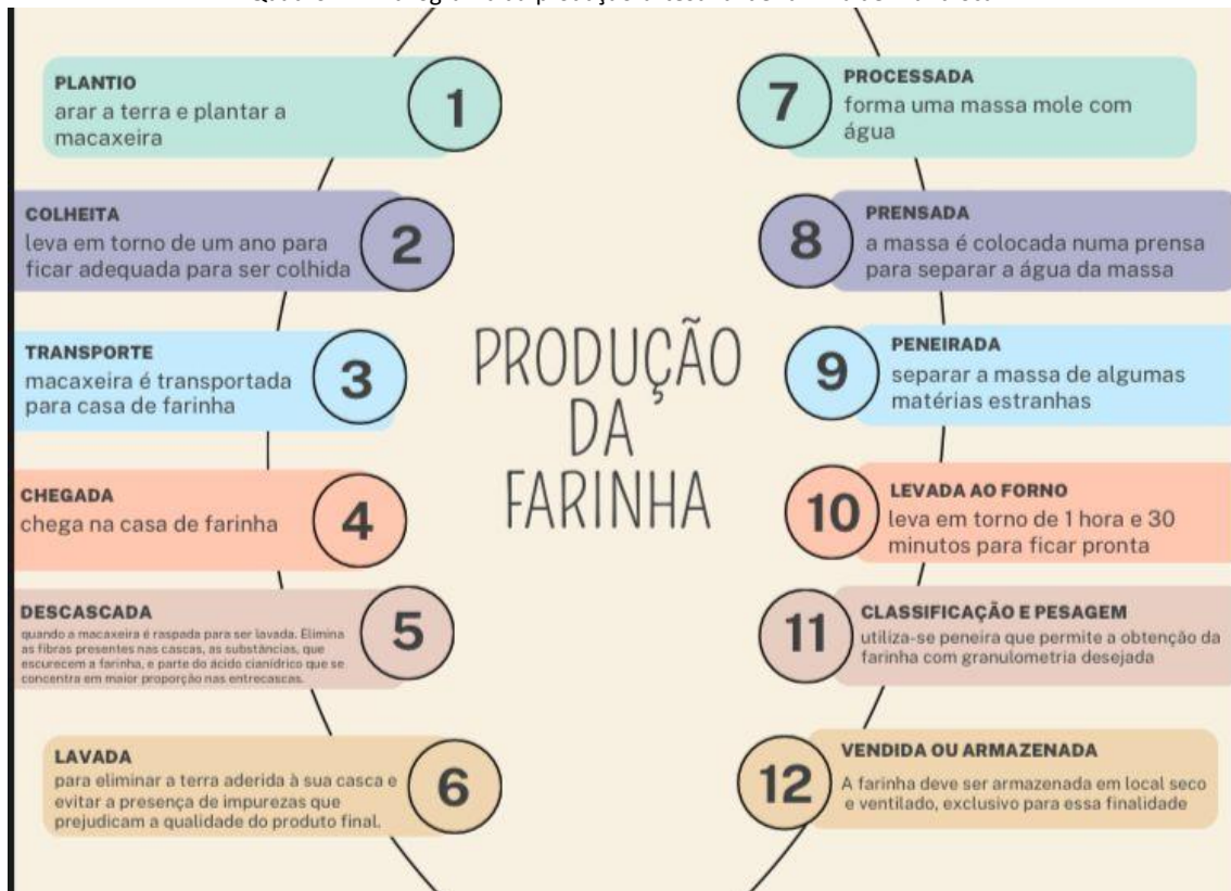
Quadro 1 – Fluxograma da produção artesanal de farinha de mandioca
