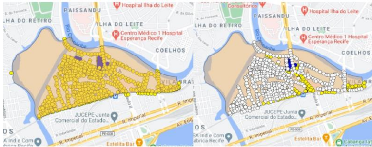
Figura 7 - Evolução do mapa de distribuição de pontos de iluminação pública no bairro Ilha Joana Bezerra nos meses de setembro de 2017 e 2020, respectivamente.
