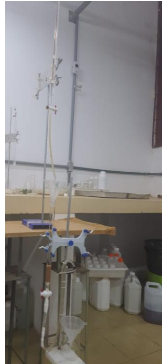
Figura 3: Filtro com gotejamento.
