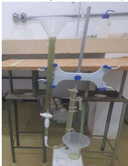
Figura 12: Fotografia do momento de colmatação do filtro durante o Experimento C.
