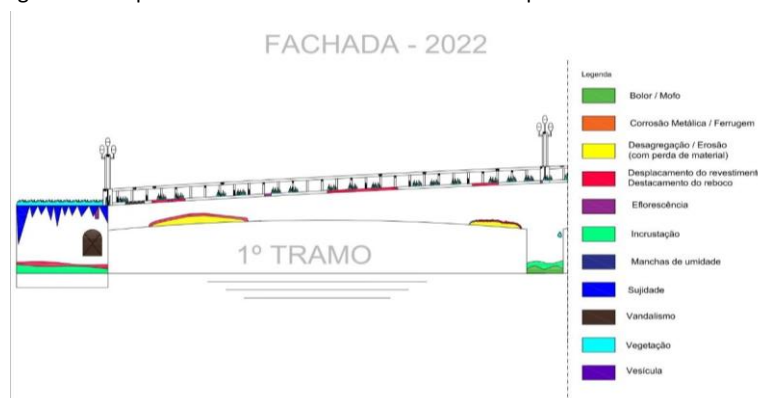
Figura 18: Mapa de danos da fachada do tramo 01 da ponte Santa Isabel - 2022.
