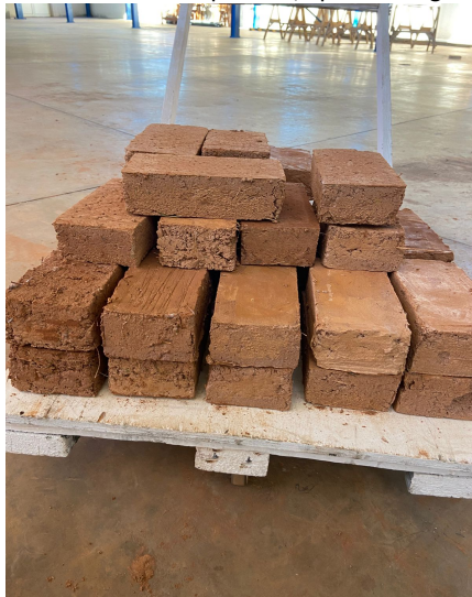
Figura 5 – Blocos de adobe prontos, após a secagem natural.
