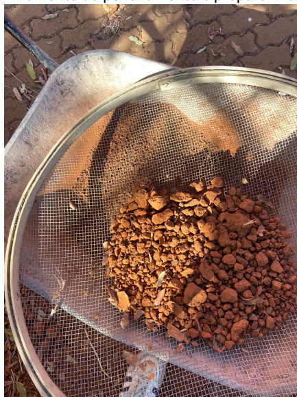
Figura 3 – Momento do peneiramento e preparo inicial do solo
