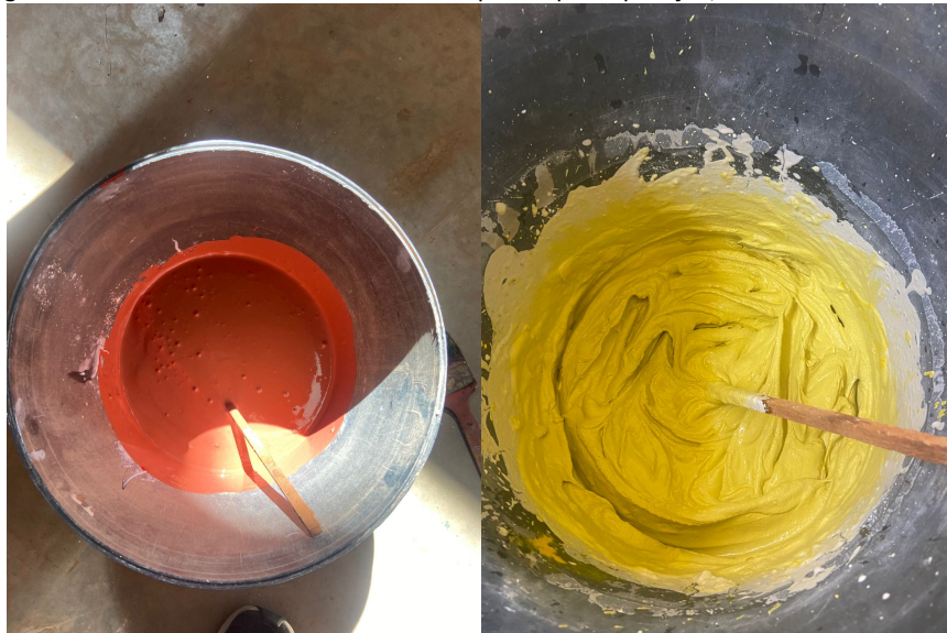
Figura 7 – Balde com a Pintura de Terra e Cal pronta para aplicação, evidenciando a textura.
