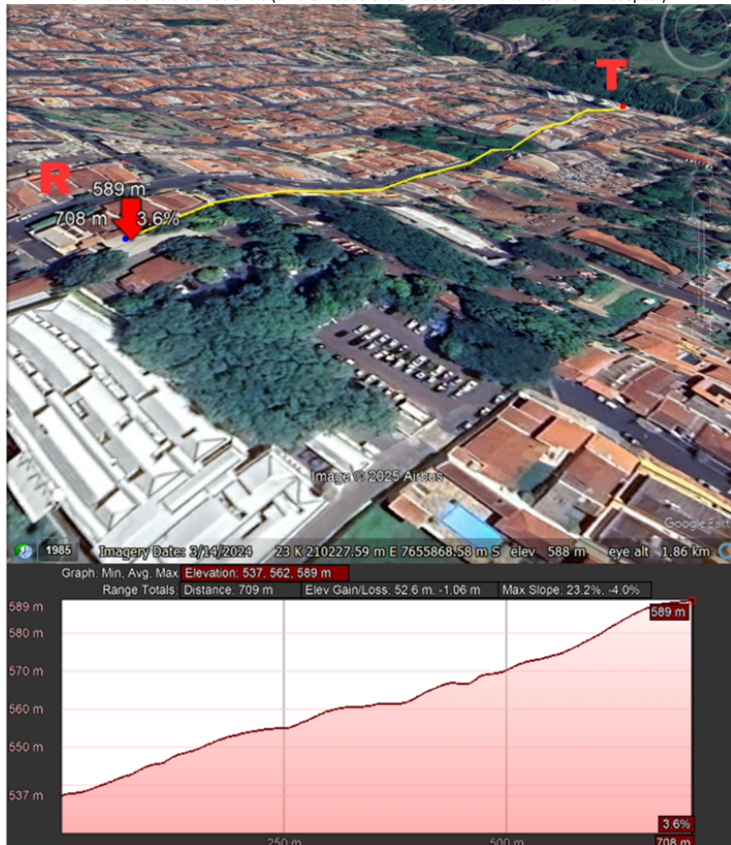
Figura 9 – Representação gráfica da topografia e distância durante o teste de alcance usando antenas omnidirecionais e direcionais (uma em cada extremidade - T: Transmissor e R: Receptor)
